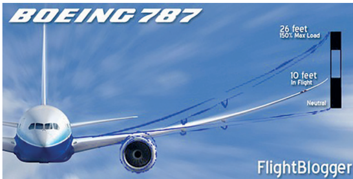
FIGURA 12. Flexión de ala en el B-787 Dreamliner
