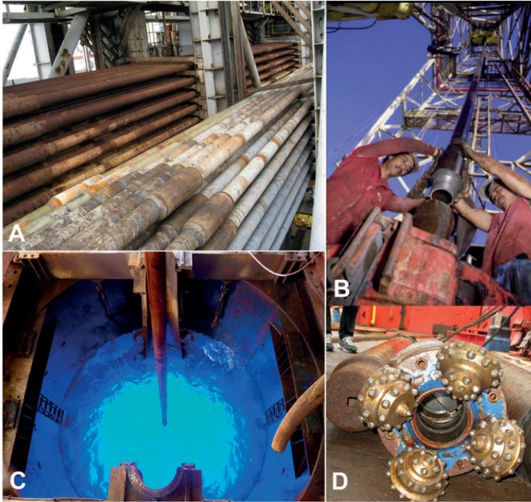
Figura 16. Detalles del Joides Resolution: A, tubos de perforación almacenados en el barco; B, sondistas colocando los tubos verticales en la torre de perforación; C, la «piscina», a través de la cual se bajan los tubos de perforación al fondo marino; D, cabezal de perforación.
