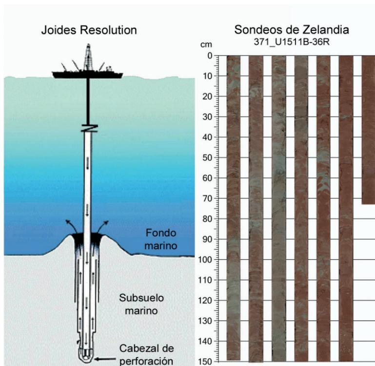
Figura 17. Esquema del buque *Joides Resolution* perforando el fondo marino para obtener sondeos como los que se muestran en la fotografía, que fueron recuperados en la llanura abisal de Tasmania a más de 4900 m de profundidad. Fotografías: IODP.
