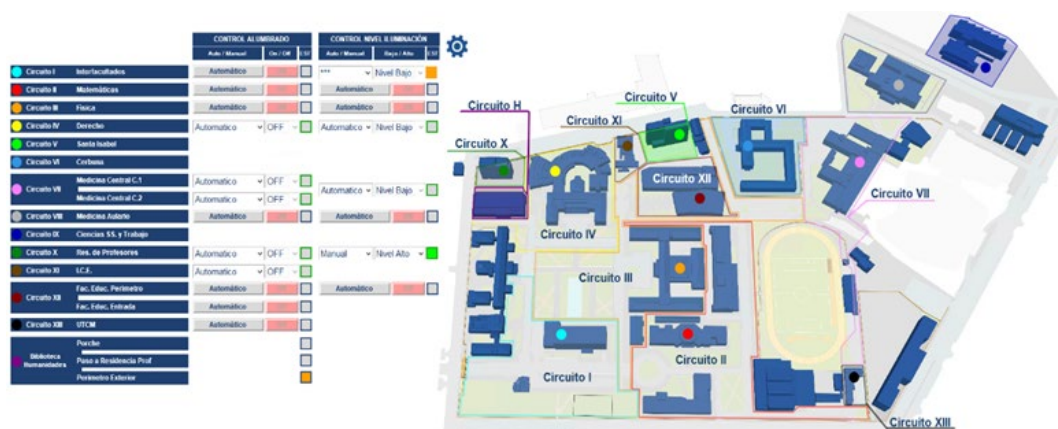
Figura XX: Sistema de consulta desde SCADA y que es uno de los modelos de visualización previsto para el nuevo visor SIGEUZ en Campus Inteligente
