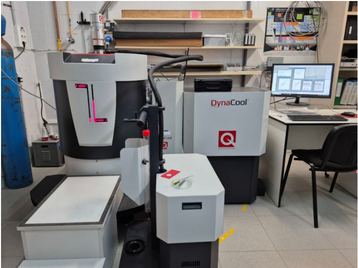
Figura 12. Plataforma subK cryofree (PPMS Dynacool) disponible en el Servicio de Medidas Físicas (Campus San Francisco).
