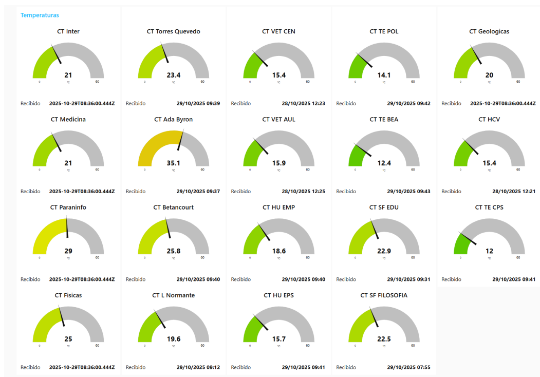
Panel de control para monitorizar la temperatura de los CTs
