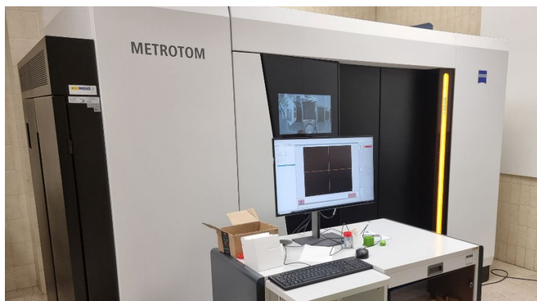
Figura 10. Equipo de tomografía computerizada por rayos-X ZEISS Metrotom 800 disponible en el Servicio de Mecánica de Precisión (Campus Río Ebro).
