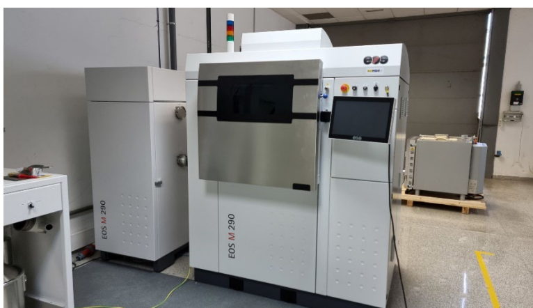
Figura 11. Máquina de fabricación aditiva de componentes metálicos EOS 290M disponible en el Servicio de Mecánica de Precisión (Campus Río Ebro).
